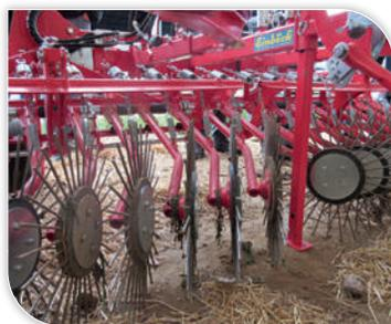
Photos : bineuse avec doigts rotatifs, herse étrille et roto-étrille
