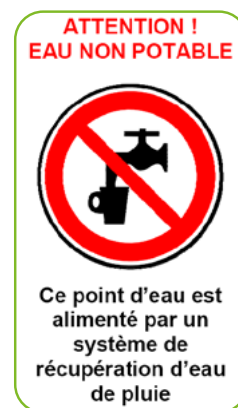
Figure 1 : Panneau d'eau non potable
